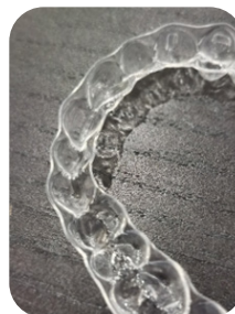
Allineatore FLEX Premium dopo i 5000 cicli di flessione del test di resistenza alla delaminazione
